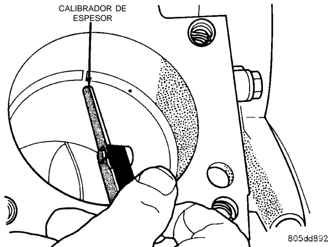
Fig. 9 Medición de la luz lateral del aro
