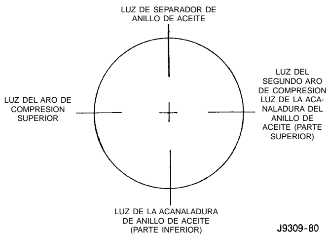
Fig. 11 Instalación correcta de aros
