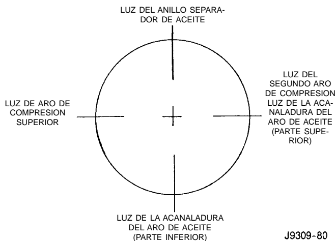
Fig. 39 Instalación correcta de los aros
